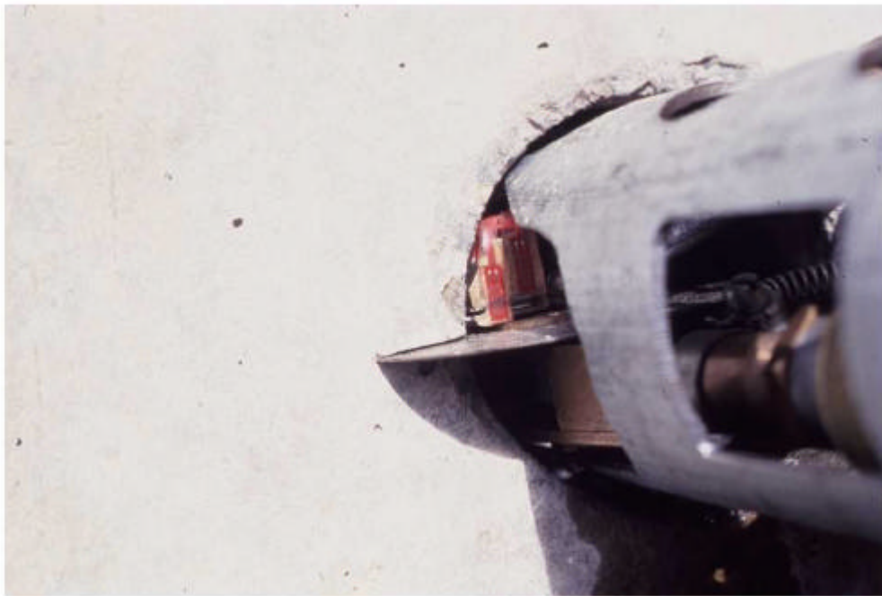
Abb. 1 Schlitzsonde am Mund eines Bohrlochs
