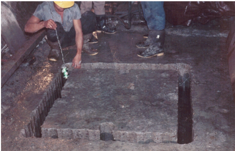
Fig 3 Entaillement de l'éprouvette en forant trou à trou
